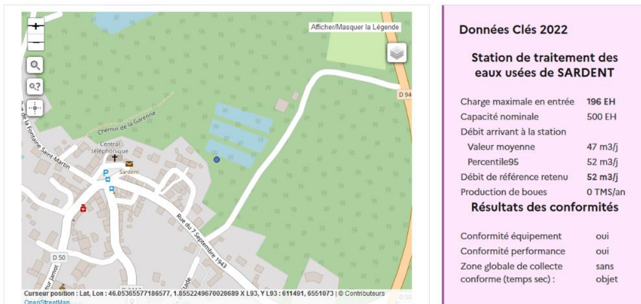
Figure 19 : Caractéristiques de la station d'épuration. (Source : assainissement.developpement-durable.gouv.fr)
